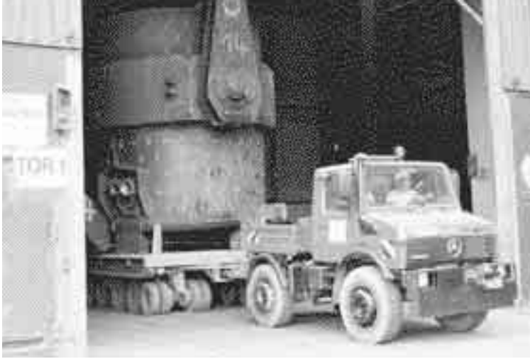
Bis zu 110 t wiegen die Stahlgießpfannen auf dem Industrieanhänger, die der U 1600 mit 214 PS und Drehmomentwandler täglich mehrfach über eine Strecke von 200 Metern zieht
