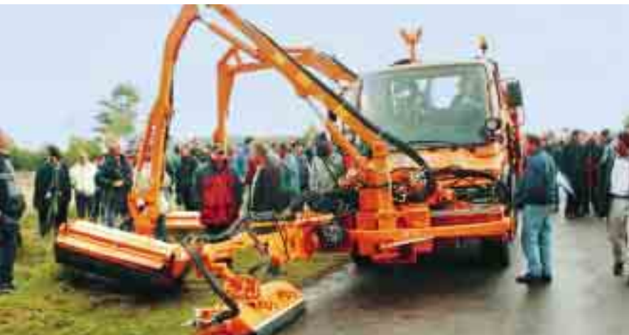
Die Mulag Trio-Mähkombination besteht aus einem Randstreifenmäher kombiniert mit einem Frontausleger-Böschungsmäher. Als drittes Gerät ist der Böschungsmäher MHU 800 auf der Pritsche aufgebaut. Die Ausleger haben eine Reichweite von 7,2 m vorn und 8,7 m hinten. Die Gesamtarbeitsbreite beträgt 3,4 m
