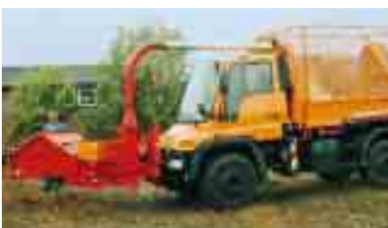
Stammdurchmesser bis 25 cm sind für den Dücker Holzhacker HF 960 kein Problem (oben). Die Holzhackschnitzel, als regenerativer Brennstoff gefragt, werden direkt in den Container auf dem Jotha-Absetzkipper geblasen
