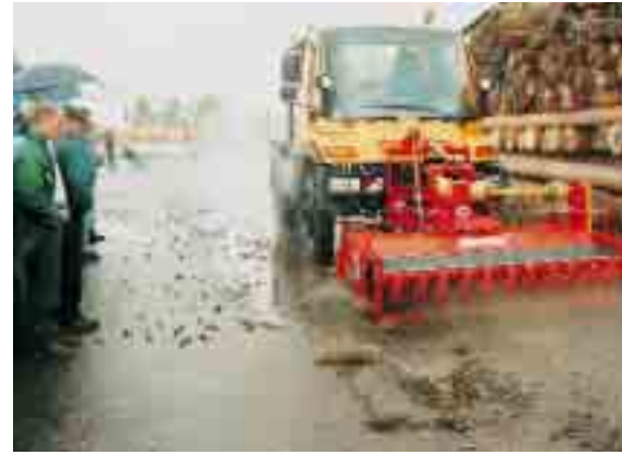
Unimog U 300 mit Dücker Frontkehrbesen, Flächenstritzbalken und Schmutzkratzer zur Beseitigung von stark verdichtetem Straßenschmutz. Die Verstellbewegungen des Geräts werden vom Fahrerplatz aus per Joystick gesteuert
