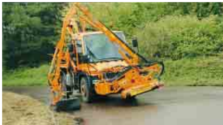
Die Mulag Wildkrautbürste ist ein Gerät, das aufgrund seiner Leistungsfähigkeit und Reinigungsintensität aus dem Straßenbetriebsdienst nicht wegzudenken ist
