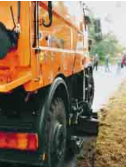
Die Faun Saugkehrmaschine AK 451 auf dem Unimog U 400 ist eine kompakte, wendige Einheit, die mit hydrostatischem Antrieb und der Wechsellenkung VarioPilot beste Ergebnisse bringt
