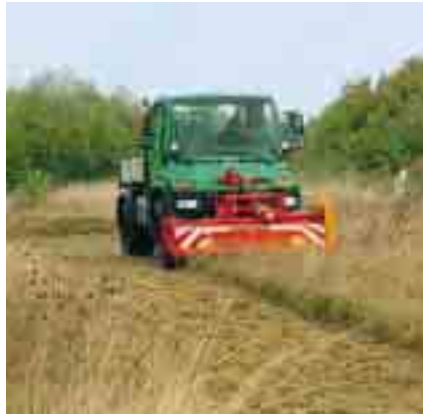
Beim Einsatz des Dücker Frontflächenmüllers UM 23 erleichtert die fahrzeugseitige Schneeflugentlastung als Geräteentlastung die Anpassung an die Bodenkontur
