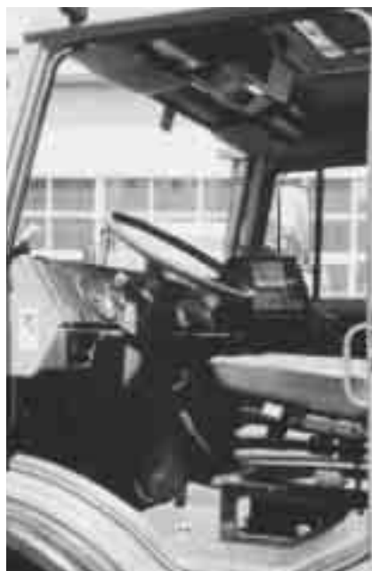
Zwei werkspezifische Ausstattungsmerkmale zeigen diese Bilder. Links die optimierte Pritsche für ein besseres Sichtfeld beim Abkuppeln und bei Rangierarbeiten. Das Datenfunkterminal im Unimog ist ein Baustein der rechnergesteuerten Transportsteuerung TESS im Werk Bremen (oben)
