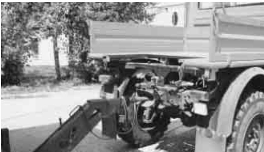
Eine speziell konstruierte Deichsel ermöglicht dem Fahrer ein schnelles Wechseln der be- und entladenen Transportanhänger (unten).
