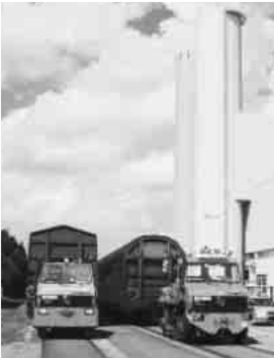
Zweiwege Unimog für das Rangieren von Bahnwaggons und das von Mercedes-Benz entwickelte Kombilifter-Bahnsystem sorgen dafür, dass viele Teile zum richtigen Zeitpunkt am Band eintreffen
