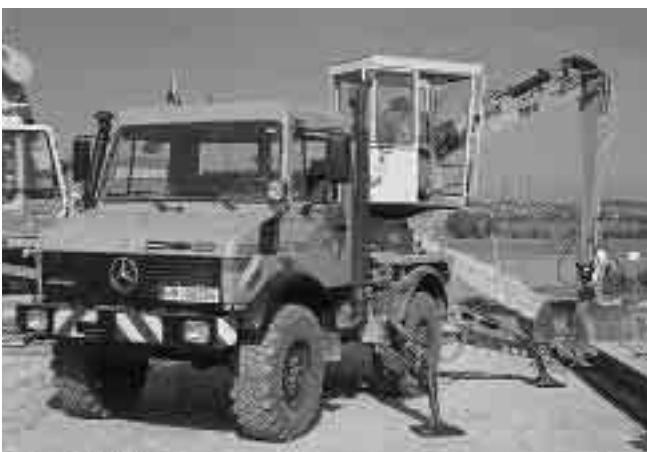
Die Kombination Unimog plus Aufbau- bagger ist für Arbeiten an neuen Bahnkörpern geradezu perfekt. Auch beim Bau der Köln-Rhein-Main-ICE- Trasse war die Firma Perzl mit ihrem Unimog U 1200 beteiligt
